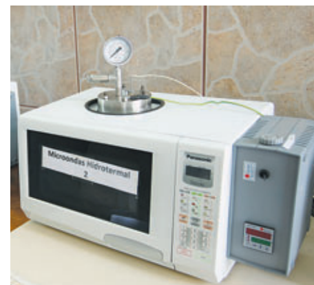
Microondas caseiro virou sistema hidrotermal
