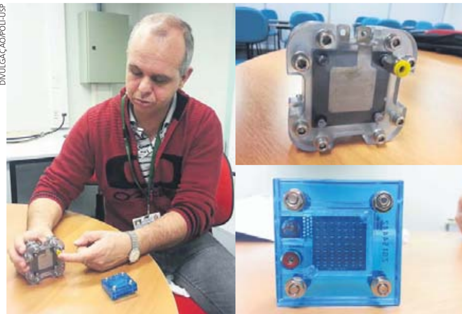
Químico Adir Moreira, com os dois protótipos de bateria movida a célula combustível
