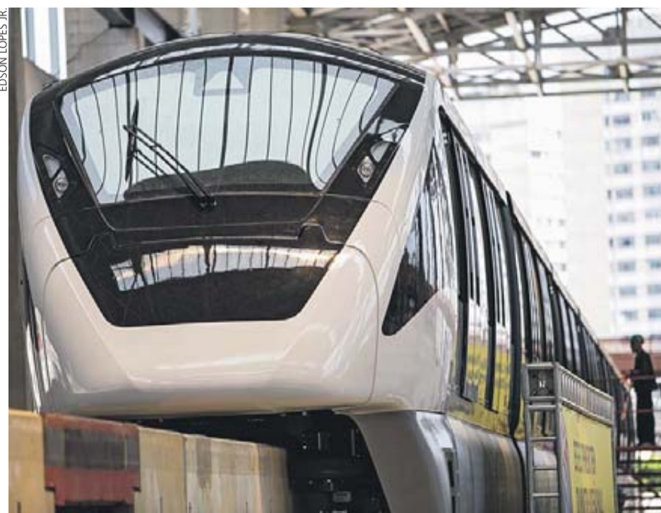
Monotrilho: sete carros, 86 m de comprimento e mais de mil passageiros por viagem
