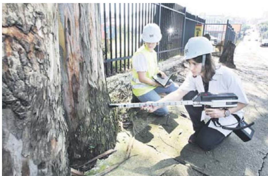
Coleta de amostras com penetrógrafo, com brocas aprimoradas no IPT, não prejudica árvores
