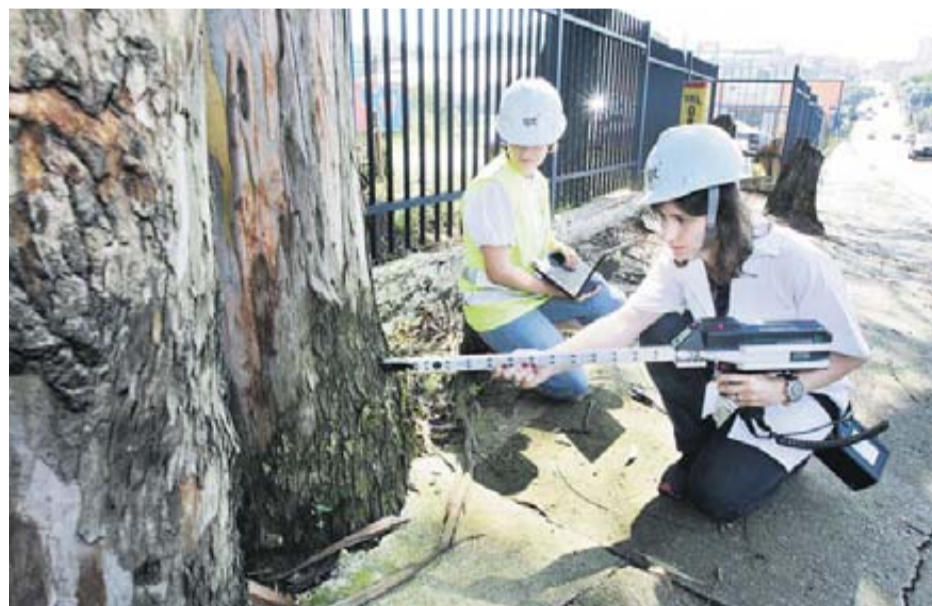
Coleta de amostras com penetrógrafo, com brocas aprimoradas no IPT, não prejudica árvores
