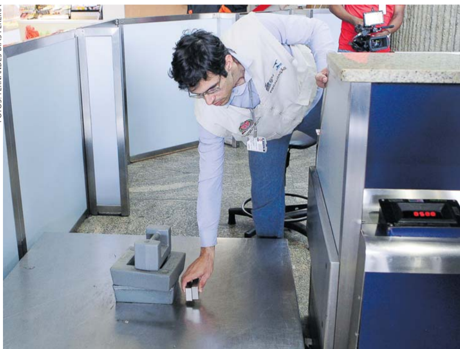
Inspeção das balanças nos balcões das empresas aéreas é feita com pesos certificados pelo Ipem-SP
