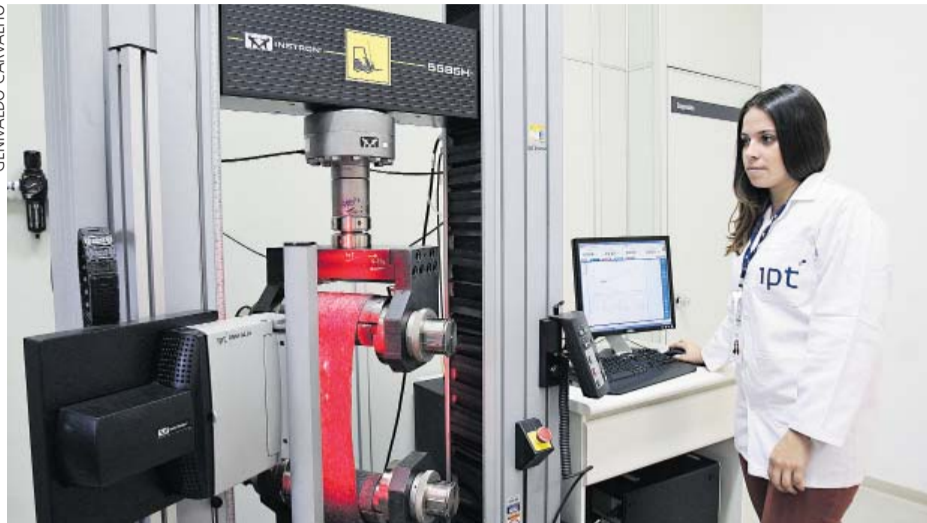
Laboratório – Gabriele utiliza o dinamômetro para avaliar a resistência das fibras do tecido
