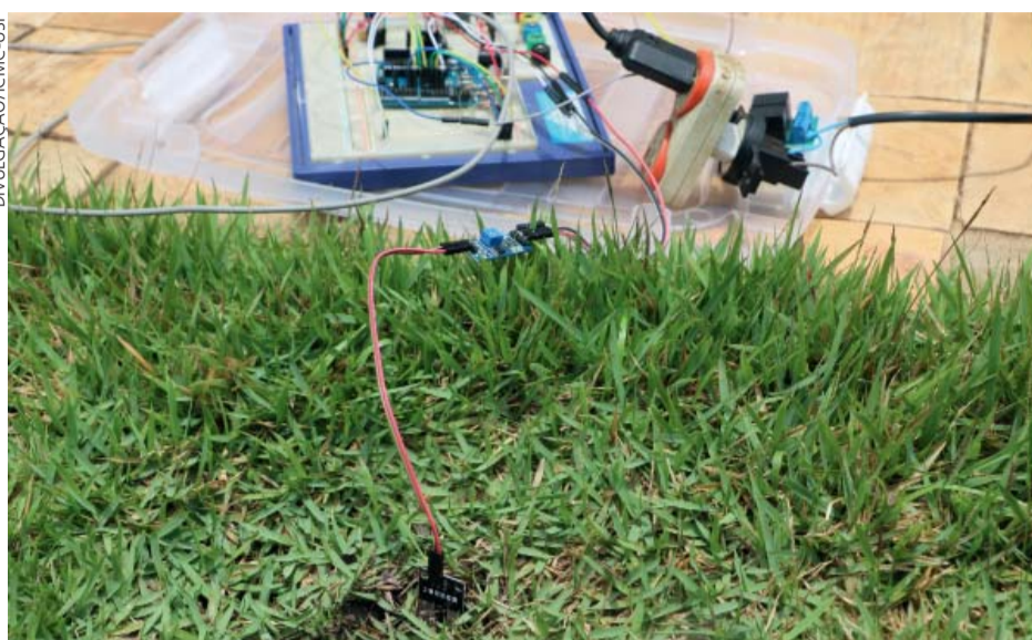
Sensor – Identifica se houve ocorrência de chuva e o volume de água captado
