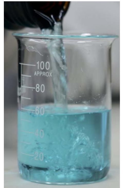
Recuperação da prata: placa-mãe (pontos de solda contêm prata); material moído antes das lixiviações; e líquido com a prata dissolvida
