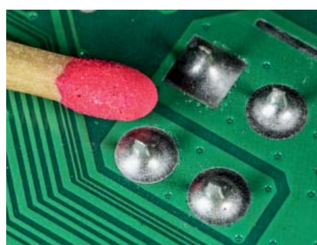
Em destaque, pontos de solda na placa-mãe
