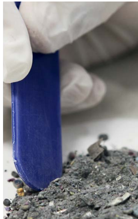
Recuperação da prata: placa-mãe (pontos de solda contêm prata); material moído antes das lixiviações; e líquido com a prata dissolvida
